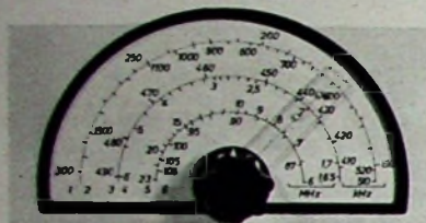
Bild 5. Die übersichtliche Skala hat für jeden der sechs Bereiche eine gesonderte Teilung
